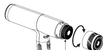
El motor se activa invirtiendo el sentido de rotación durante 15 segundos, expulsando la suciedad del filtro y de las partes internas. Al final de la operación, volver a montar el filtro (3).
