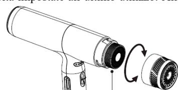
Il motore si aziona invertendo il senso di rotazione per 15 secondi, espellendo lo sporco da filtro e parti interne. Al termine dell'operazione, rimontare il filtro (3).
