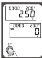
La fonction tare est à utiliser pour effectuer des pesées successives en utilisant différents récipients, ou quand l'écran ne montre pas zéro avec le récipient déjà appuyé sur la balance.
