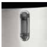
Finestra per vedere il livello acqua
